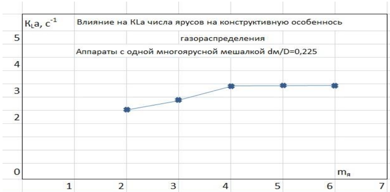
Рисунок 2. Влияние на KL_a числа ярусов на конструктивную особенность газораспределения
