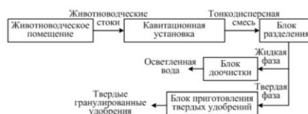
Рисунок 1. Технологическая схема кавитационной обработки жидкого навоза
