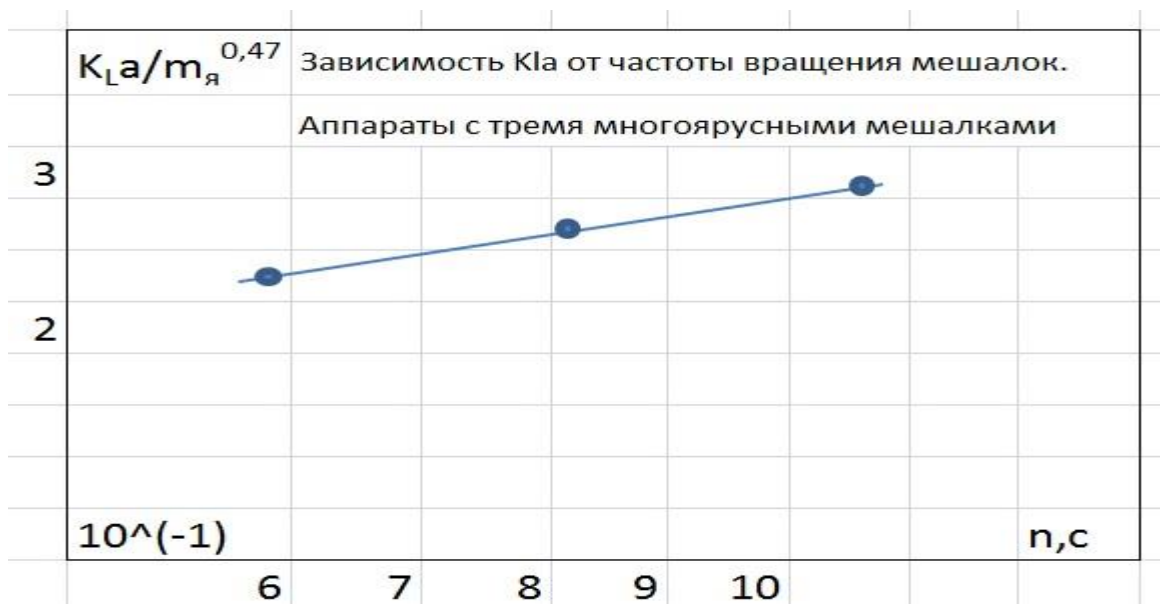
Рисунок 3. Влияние на KL_a числа ярусов на конструктивную особенность газораспределения (аппараты с многоярусной мешалкой)
