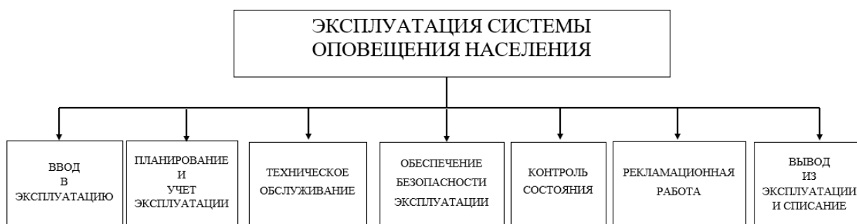
Рисунок 1 – Комплекс мероприятий по эксплуатации системы оповещения населения
