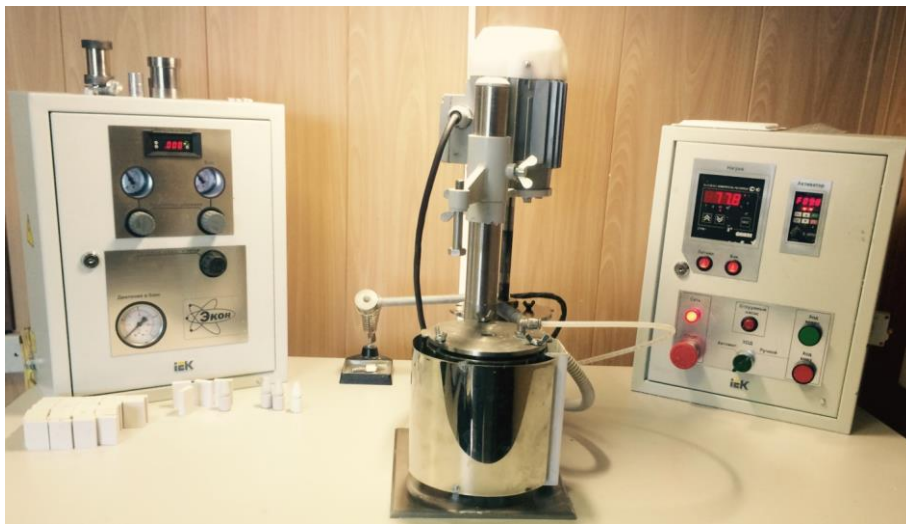
Рисунок 1. Установка для горячего шликерного литья под давлением (ЭКОН-УГШЛ)
