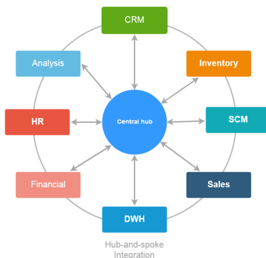
Рисунок 2 – Схема реализации подхода «Hub-and-spokes» в системе с восьмью компонентами
