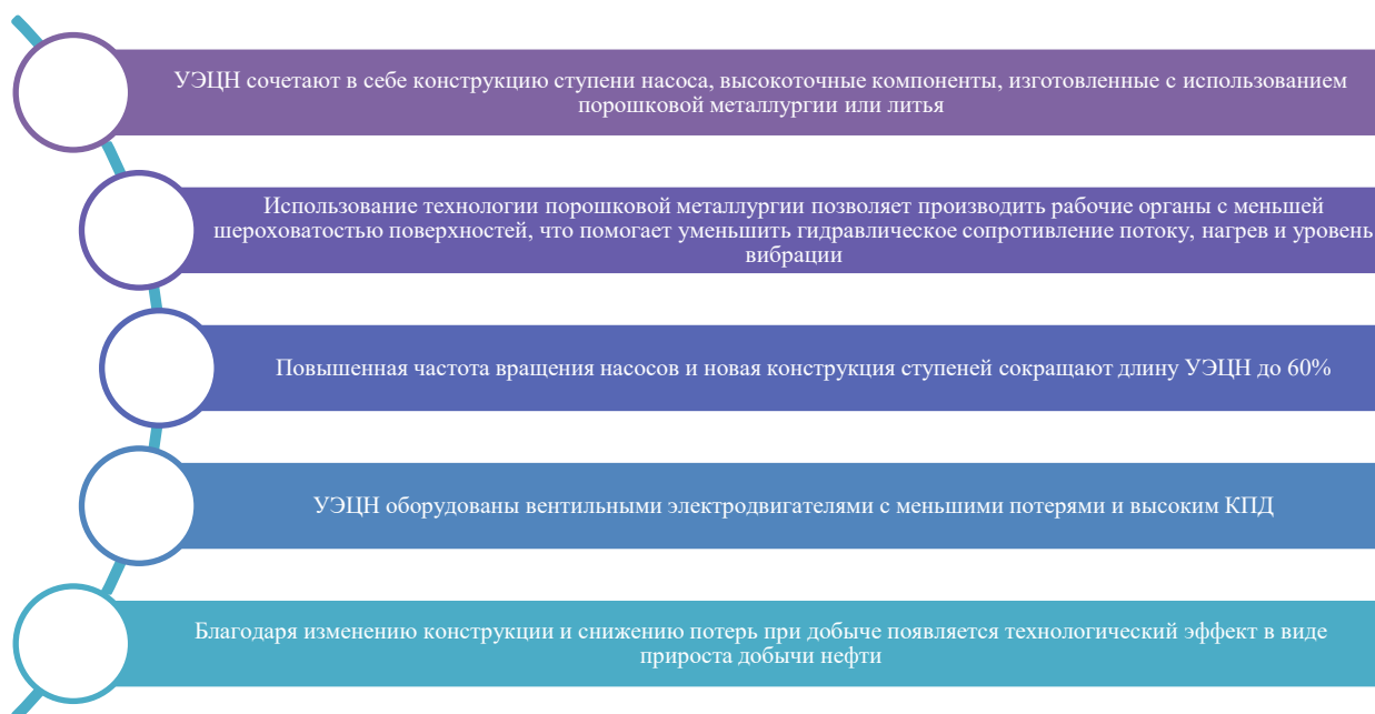
Рисунок 5 – Свойства УЭЦН. С повышенным КПД
